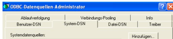
Wählen Sie dann das Register „System-DNS“ und anschließend den „Hinzufügen“-Button.
